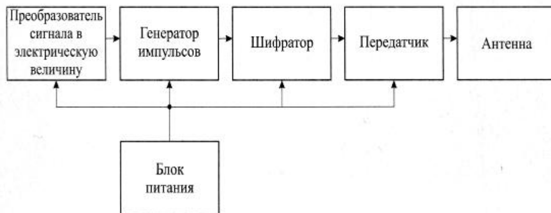
Фиг. 3 Структурная схема сигнализационного датчика.
